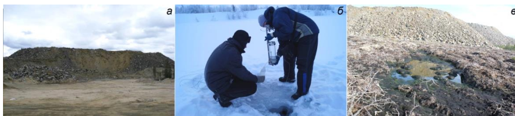
Рис. 1. Отвал Аллареченского месторождения медно-никелевых руд в Печенгском районе Мурманской области: а — общий вид отвала; б — отбор проб воды затопленного карьера; в — техногенная пустошь вблизи подошвы отвала
